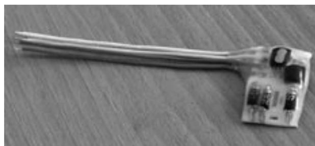
Приставка АПСТ устанавливается в телефонной розетке или коммутационной коробке. Подключение производится через выводы (красный/синий – линия, два одноцветных – телефон). У абонента Б провода подключаются противоположно подключению линейных проводов абонента А.
