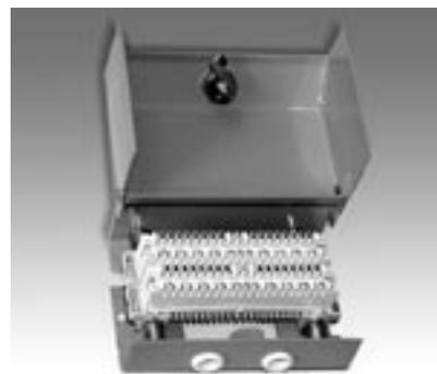
Предназначены для установки на распределительных участках абонентских линий ГТС в зданиях, где находятся абонентские устройства. В коробках происходит соединение пар распределительного кабеля с абонентскими проводами (ТРП, ТРВ и т.п.). Коробки устанавливаются на вертикальных (стены) и горизонтальных (ниши) плоскостях.
