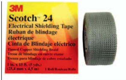
**Scotch™ 24** – Гибкая токопроводящая лента из покрытой оловом медной проволоки. При намотке с натяжением лента уплотняется, благодаря чему обеспечивается прилегание ко всем профилям без образования складок. Устойчива к влаге, коррозии, УФ, растворителям и маслам. Применяется для экранирования кабельных соединений, восстановления экрана кабелей, выравнивания электрического потенциала.
