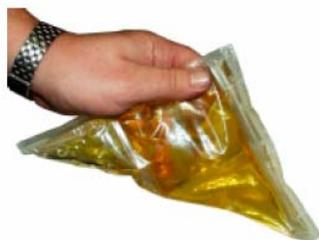
Отрежьте угол упаковки и аккуратно выдавите компаунд в отверстие муфты МПП до полного заполнения внутреннего объема муфты, не допуская перелива. Закройте отверстия пробками и зафиксируйте их лентой 88Т.
