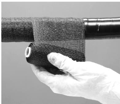
Сетчатая лента из стекловолоконной ткани пропитанная полиуретановым составом, твердеющим при попадании влаги. Не требует открытого пламени или нагрева. Образует прочную долговечную оболочку, стойкую к воздействию влаги, грибка, кислот, щелочей, УФ-излучения, растворителей, высоких температур и повреждениям грызунами
