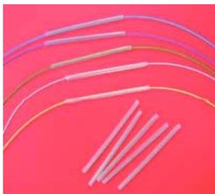
Комплект деталей защиты сростка (КДЗС) оптического волокна представляет собой прозрачную двойную пластиковую трубку с клеевым подслоем и стержнем из нержавеющей стали. Это обеспечивает надежную защиту сростка без дополнительных материалов.
