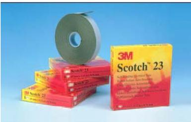
**Scotch™ 23** – Высокоэластичная изоляционная лента на основе этиленпропиленовой резины, применяется для первичной изоляции и защиты от влаги кабельных муфт, герметизации электрических соединений, изоляции шин, концевой уплотнения высоковольтных кабелей. Лента **Scotch™ 23** совместима со всеми твердыми диэлектриками применяемыми для изоляции кабелей. Содержит разделительный лайнер, который отделяется при намотке и предотвращает загрязнение поверхности ленты при монтаже.
