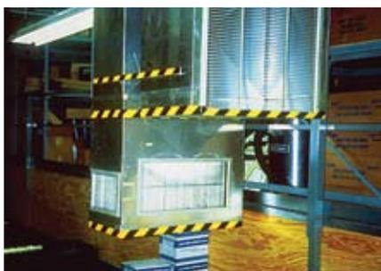
Сигнальное обозначение выступающих деталей конструкции
