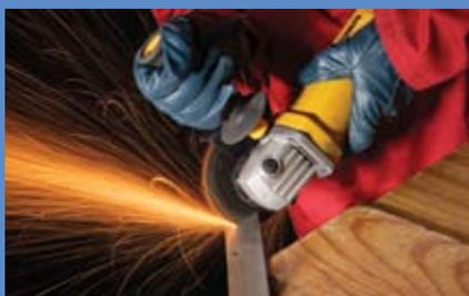
Отрезка металлического уголка
