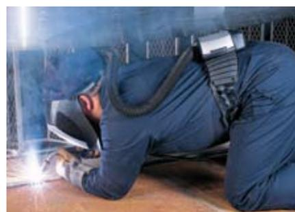
**Система фильтрации и принудительной подачи воздуха 3M™ Adflo™** в подмасочное пространство. В комплекте со сварочным щитком Speedglas™ — это комплексное решение для защиты глаз, дыхания и лица. Блок фильтрации, компактный и плоский, позволяет проводить сварочные работы в очень узких пространствах. Чистый воздух, подаваемый на лицо сварщика — это значительное улучшение его условий труда
