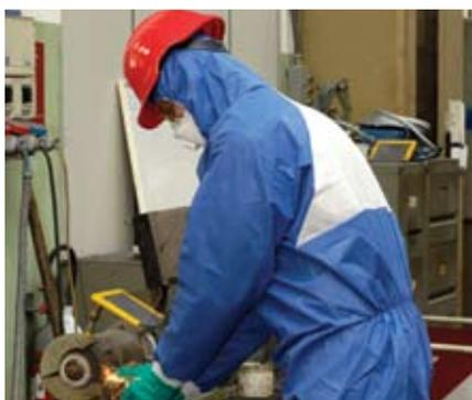
**Защитные комбинезоны 3М™ 4530/4540** надежно защищают человека от пыли, кислот, щелочей, растворителей и воды в виде брызг и аэрозолей при малярных, штукатурных и прочих работах. Комбинезоны изготовлены из воздухопроницаемого, дышащего материала, надежно защищают кожу и не стесняют движения.
