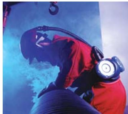
**Система фильтрации и принудительной подачи воздуха 3М™ Jupiter™** применяется в условиях повышенной запыленности, повышенных температур и высокой влажности. Система обеспечивает самый высокий уровень аэрозольной защиты без сопротивления дыханию. Подаваемый в подмасочное пространство чистый воздух улучшает условия работы.
