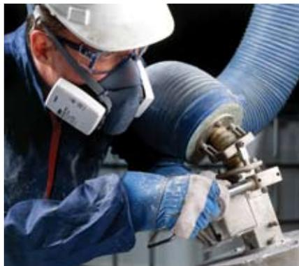
**Маски и полумаски с изолирующей лицевой частью и сменными фильтрами 3М™** обеспечивают комплексную защиту лица, глаз и дыхания при работе с растворителями, кислотами и другими агрессивными веществами. Полумаска изготовлена с применением силикона, который поддерживает температуру лица, как на жаре, так и на морозе. Система крепления позволяет легко снимать полумаску, не снимая другие средства индивидуальной защиты, включая каску.
