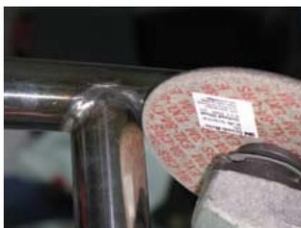
Удаление сварного шва при Т-образном соединении труб
