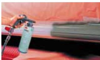
Уникальные антигравийные покрытия на водной основе благодаря особому составу могут наноситься как при помощи пистолетов 3М™ 08996 и 08991, так и при помощи грунтовочного пистолета, дают возможность воспроизводить любую шагрень – от абсолютно гладкой до текстурной. Время выдержки – 30 мин.
